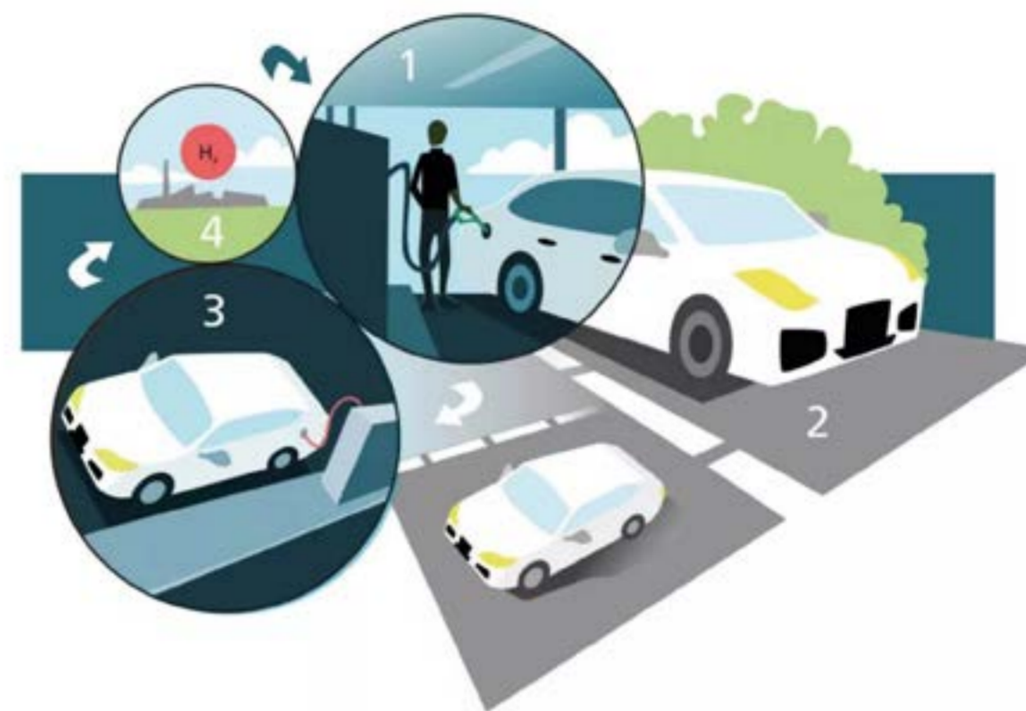
En bil tankas med en vätska som innehåller väte. Drivmedlet passerar genom katalysatorn, där väte frigörs till en bränslecell. När vätet är slut tömmer man och fyller på ny vätska på tankstationen. Den gamla vätskan laddas med väte igen och återanvänds.
