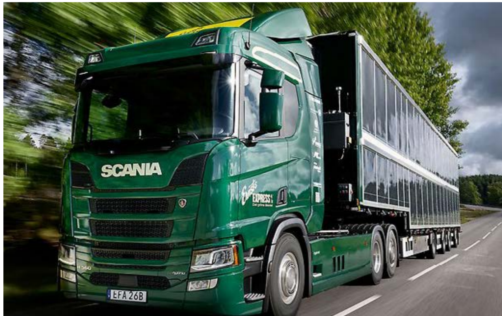
Lastbilen används i ett forskningsprojekt för att studera solenergin som genereras och hur mycket lägre koldioxidutsläppen blir med hjälp av solcellerna.
