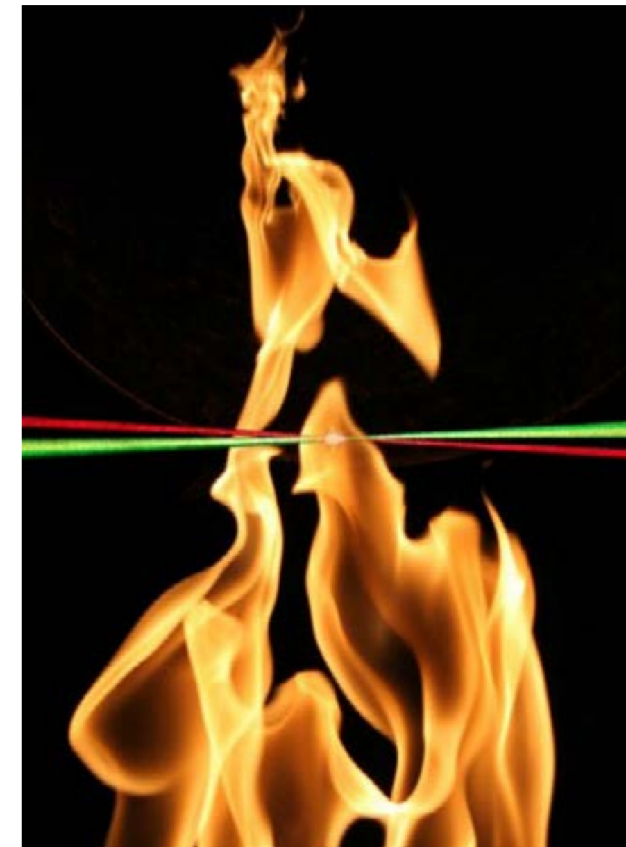
Med hjälp av laserstrålar kan forskare blicka in i flammans innersta och ända ner på molekylnivå få reda på vad som sker när olika bränslen förbränns. Här mäts ska de testa järn, kisel, aluminium och ammoniak, bland annat. Bild: Henrik Bladh.
